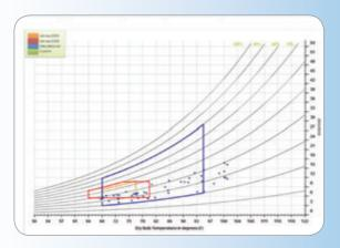
Power IQ – 利用 Raritan 的環境感應器,EMX 即宛如一個資料閘道,可將溫度、濕度、氣流、氣壓和接觸閉合等資訊供應給 Raritan的電源管理軟體及資料中心監控軟體 Power IQ。Power IQ 可建立多種報告和圖表,亦可在超出臨界值時發送警告。獨一無二的 Power IQ 降溫圖表可讓您瞭解您是否符合製造商和業界公認的建議值,並預測提高機房的週遭溫度所能省下的成本。
