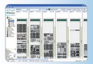
dcTrack – 利用 Raritan 的智慧型資產管理標籤 (AMT) 和資產管理感應器 (AMS),EMX 可即時將資產位置提供給 Raritan 的資料中心基礎設備管理 (DCIM) 軟體 dcTrack,以利精確追蹤最小至 1U 機架空間層級的資產位置。
