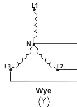
由於 Delta 和 Wye 之間的差異在於是否有中線存在，所以許多資料中心都採取 Wye 的排線方式，並使用尾端連接 NEMA L21-30R 之類的 Wye 插座的纜線。這表示資料中心可以使用支援 120V/208V 的 Wye PDU，或使用僅支援 208V 的 Delta PDU，而不需要變更資料中心的排線方式。Delta PDU 使用 NEMA L21-30P（搭配的 Wye 插頭），但不會在 PDU 內部使用中線線。這是完全可接受的做法。例
